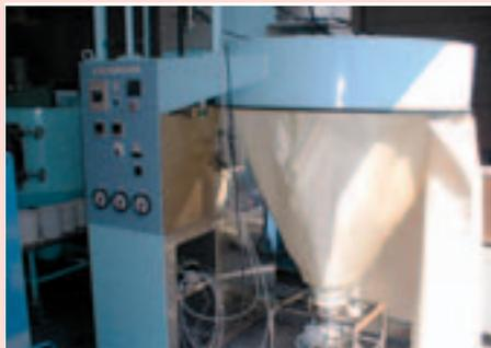
図1 バッグ式スプレードライヤ
